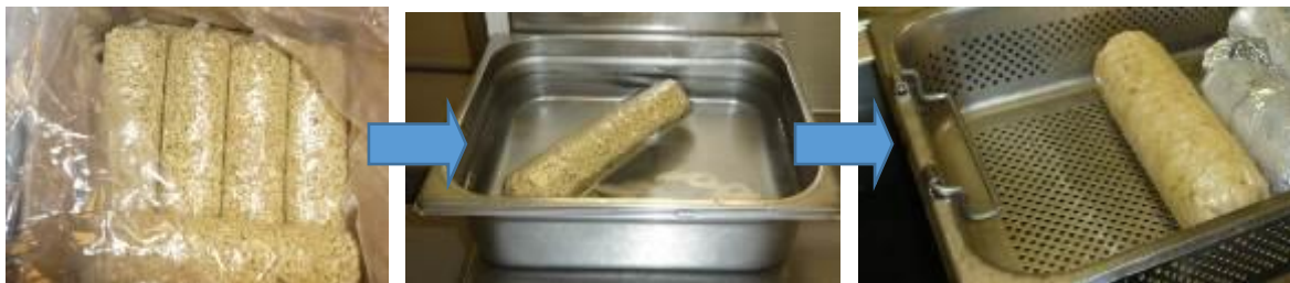
Abbildung 2-1: Herstellungsprozess der Serviettenknödel als Fertigprodukt - LIN [Daxbeck et al., 2014]
